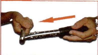
ENFILER LA POIGNÉE EN CAOUTCHOUC SUR LA STRUCTURE EN INOX
