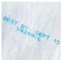
Cette encre bleue à base d'éthanol, lavable et indicatrice d'humidité, devient invisible et se dissout complètement lorsqu'elle est exposée à l'eau ou à d'autres liquides aqueux. Elle est essentiellement utilisée comme indicateur visuel d'humidité sur les couches absorbantes et les produits d'incontinence. Elle peut également être utilisée sur des plateaux ou des conteneurs en lots qui nécessitent une élimination très facile à l'aide d'une simple solution aqueuse.
